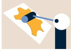
Le lissage ou satinage est destiné à rendre le cuir lisse et brillant. Il est réalisé par frottement d'un cylindre de verre ou d'agate sur la fleur ou par pressage du cuir contre une plaque chauffée.
