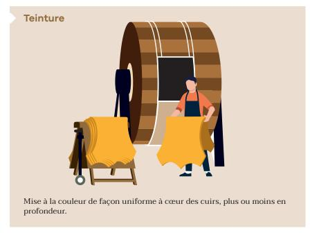
Pour obtenir la teinte recherchée, le maître teinturier procède à plusieurs essais de bains de teinture. Une fois teints, les cuirs sont à nouveau essorés, mis au vent, séchés, humidifiés et palissonnés.
