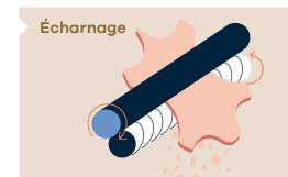
Les peaux sont passées sous des rouleaux équipées de lames afin de retirer l'excès d'épiderme et de graisse restant.
